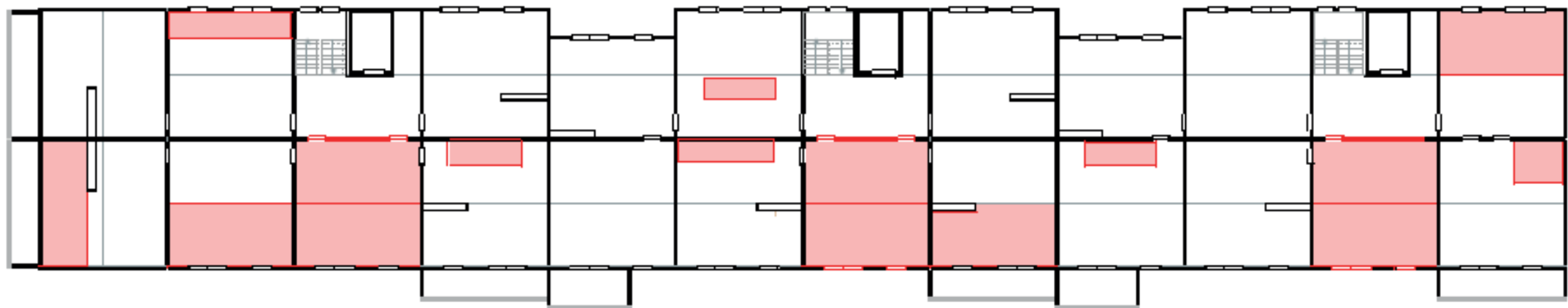
Sloop: deel van de stabiliserende elementen typeverdieping 3
