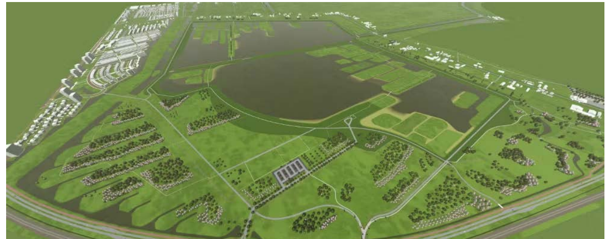
De nieuwe Driemanspolder in Zoetermeer is aangelegd als piekberging, natuurgebied en recreatiegebied. Er zijn in het gebied verschillende niveau's aanwezig. (cobouw, zd)
