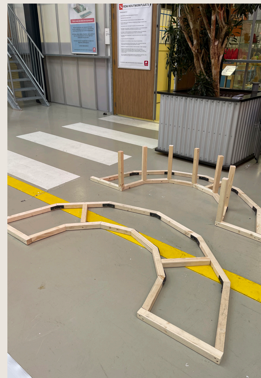
Onderstel voorzien van de eerste pootjes. Frame voor de zitting wordt bevestigd nadat het onderstel voorzien is van alle poten.
