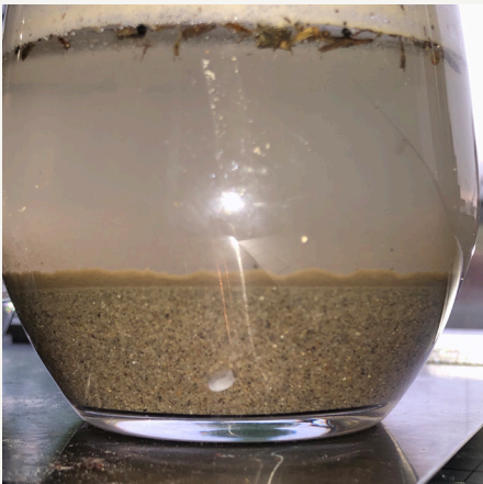
proef om de bestanddelen van aarde te analyseren
