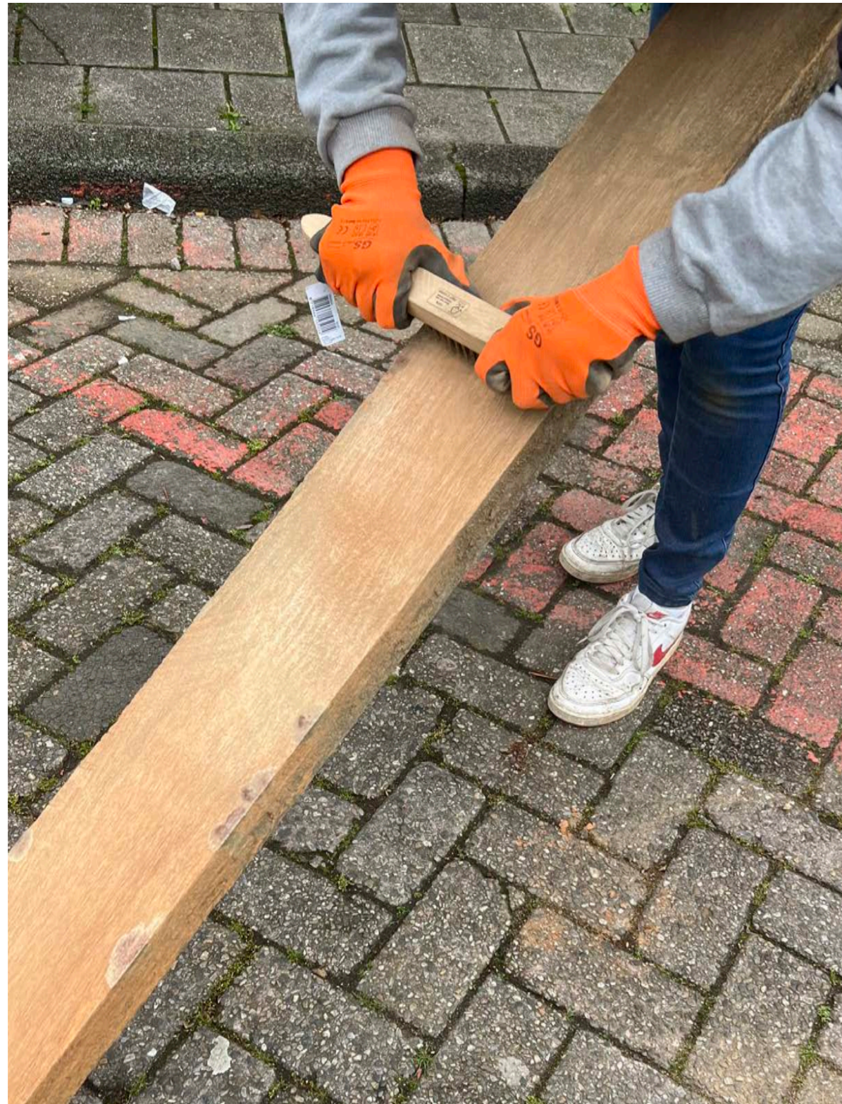
Status bewerking staalborstel
