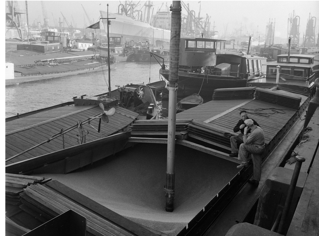
Lossen in de haven de vrachtboten werden leeggepompt met grote elevatoren
