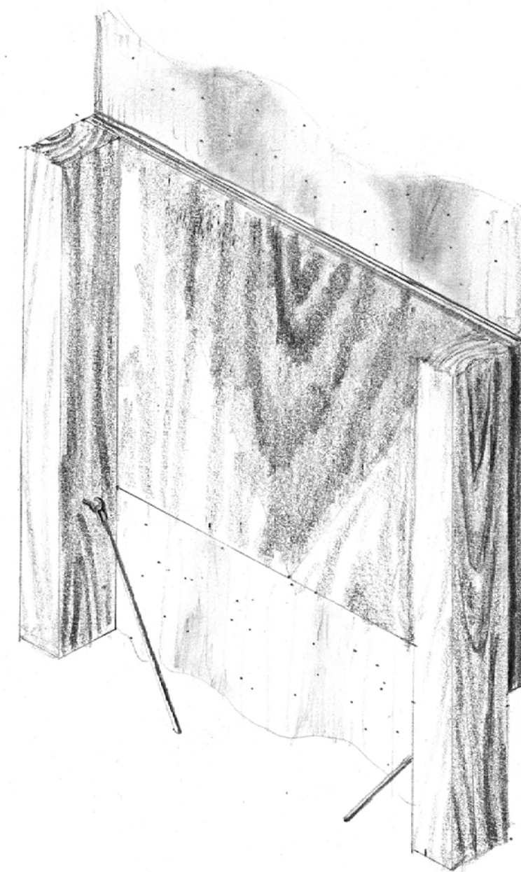
De modulaire panelen zijn vervaardigd uit gestandaardiseerde houten elementen en een wind- en waterdicht canvas
