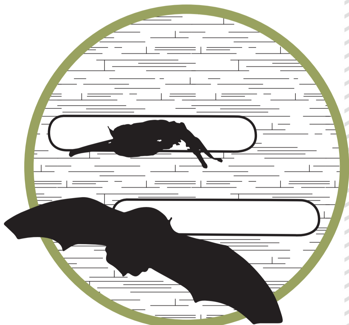
Nestspleten in betonnen gevel 80 bij 15 mm dwergvleermuis / zuid- en westgevel
