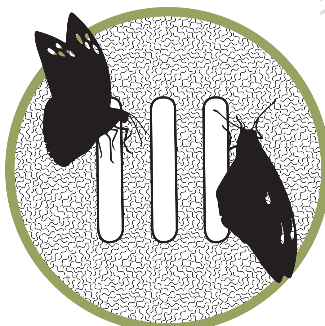
Nestspleten in houten onderdelen van de constructie van 1 tot 12 bij 60 tot 100 mm voor vlinders / zuid- en -oostgevel
