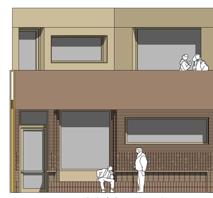
06 - verfijning in de gevel, metselwerkpatronen, railing langs de gevel, spouw in de gevel
