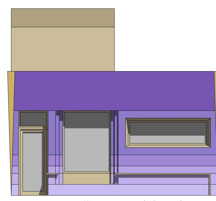
04 - primaire gaten negges in baksteen, secundaire gaten gepoint in gevel en afgewerkt met secundair materiaal
