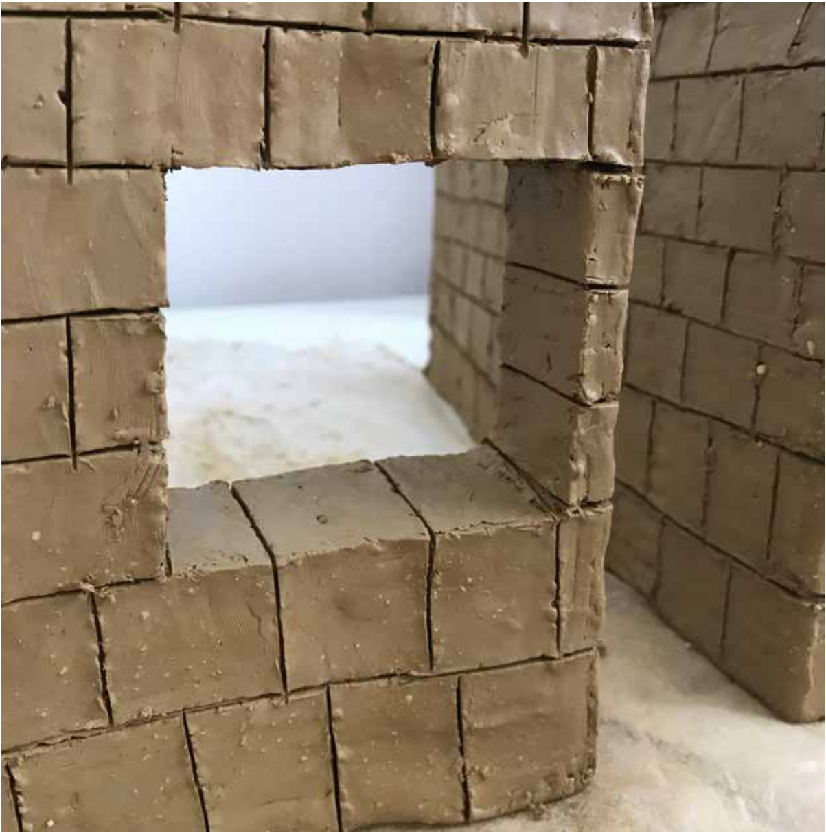
Het gat, in halfsteensverband, bestaat uit 3 steenlagen en 5 koppen
