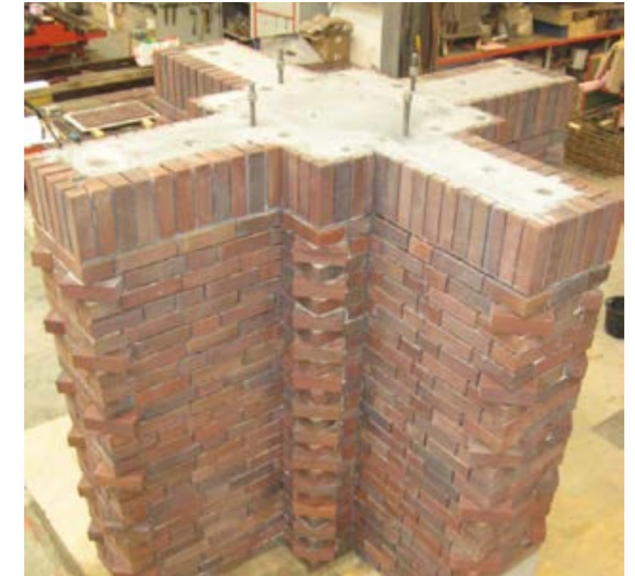
3 Prefab metselwerk kruiskolom - Bron: Stahlbeton Albert
