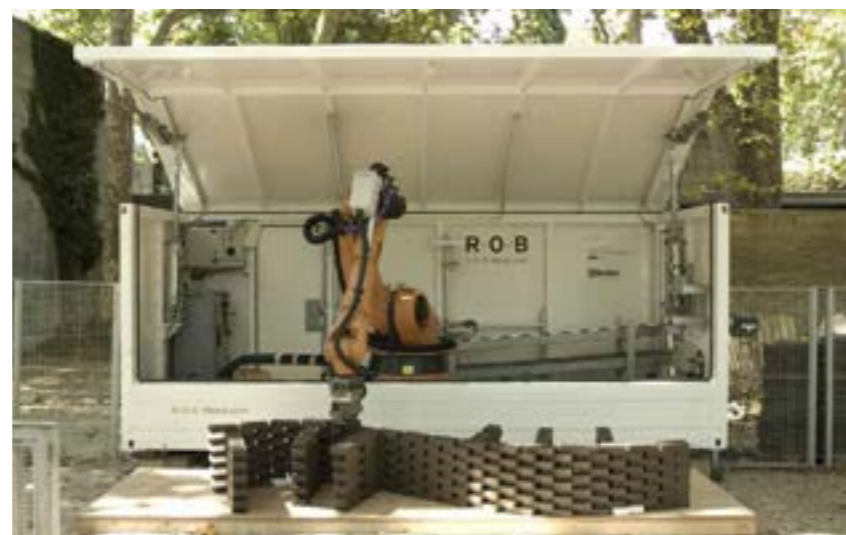
2 Demonstratie metselwerkrobot, bron robotmetselwerk
