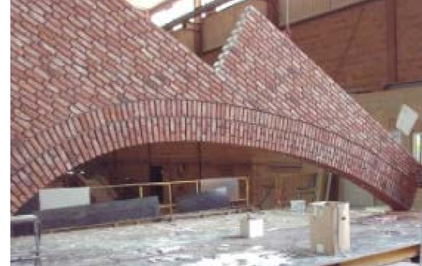
1 Prefab metselwerk boog - Bron: Stahlbeton Albert
