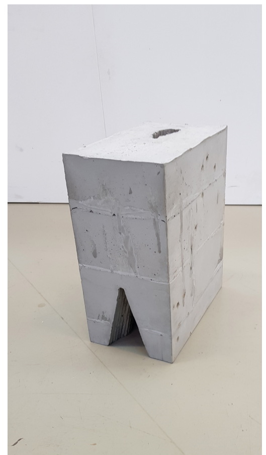
Het maken van de mal, eerst de ruimte daarna de kist, vervolgens verschillende lagen storten.
